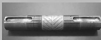
●磁性金属ガラス溶射したシャフトと磁歪式トルクセンサ
