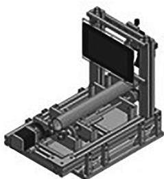
画像処理を用いたパイプシーム検出の自動化
