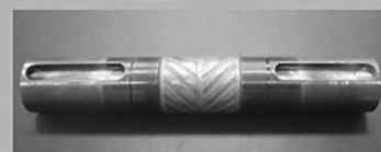
●磁性金属ガラス溶射したシャフトと磁歪式トルクセンサ
